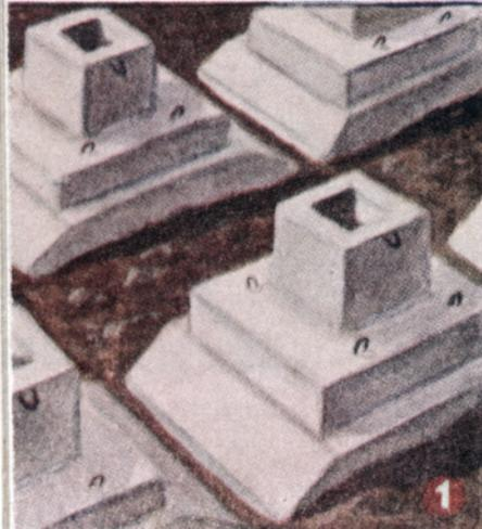
ПРЕВРАТИТЬ стройки в сборно-монтажные площадки — такова одна из основных задач, поставленных ныне перед строителями. Одним из методов, позволяющих решить эту задачу, является строительство жилых каркасно-панельных зданий. Все детали для такого здания изготавливаются на заводе из железобетона и собираются монтажниками на строительной площадке.
